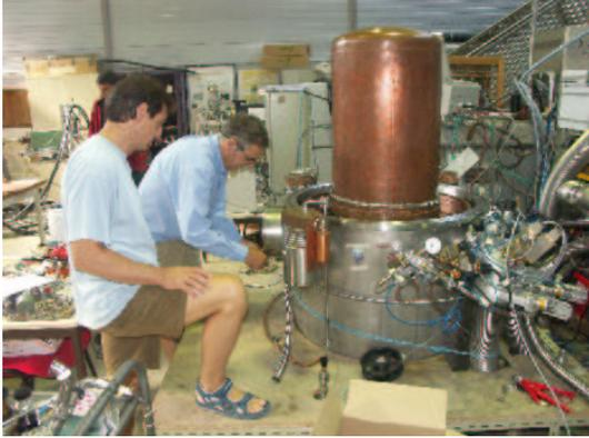
Figure 3: Le cryostat à dilution  $^3\text{He}/^4\text{He}$  d'EDELWEISS-II, d'un volume utile de 100 litres, permet d'atteindre des températures inférieures à 10 mK en se dispensant presque totalement de fluides externes (azote et hélium liquides)
